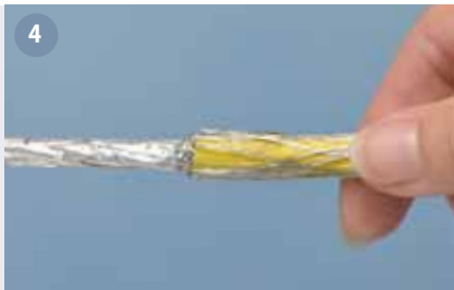
4 Schirmgeflecht über den Kabelmantel ziehen. Pull back the copper braid.
