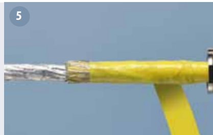
5 Schirmgeflecht mit Isolierband fixieren. Fix the copper braid with tape.
