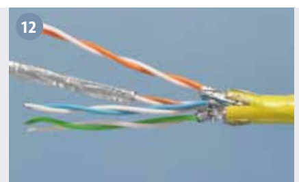
12 Folienschirm bis auf 5 mm entfernen. Strip the foils down to 5 mm.
