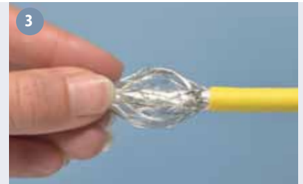
3 Schirmgeflecht zurückschieben. Push back the copper braid.
